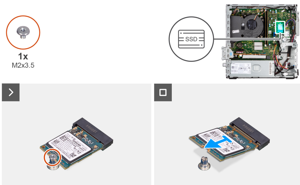
Rysunek 17. Wymontowywanie dysku SSD M.2 2230
