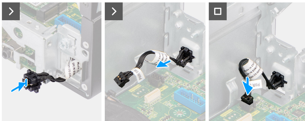
Rysunek 36. Instalowanie przycisku zasilania
